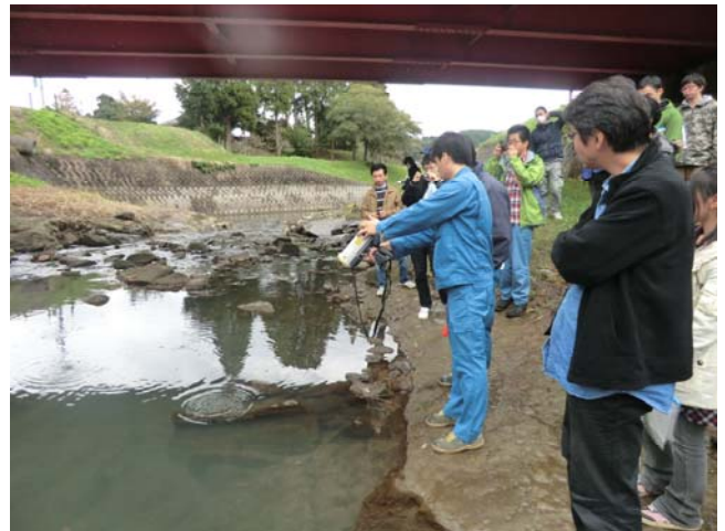
第10図 レーザー光線測定器によるメタンガス濃度測定の様子。
