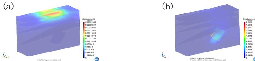
図 7c 流体流動シミュレータと連成解析した際の全体変位
