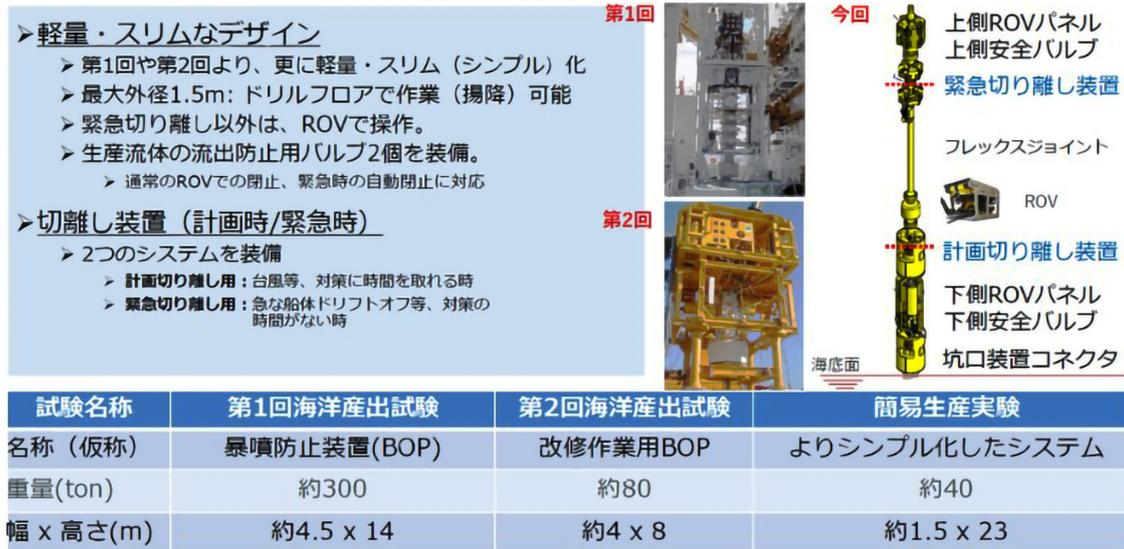
図7 坑口，切り離し装置変遷
